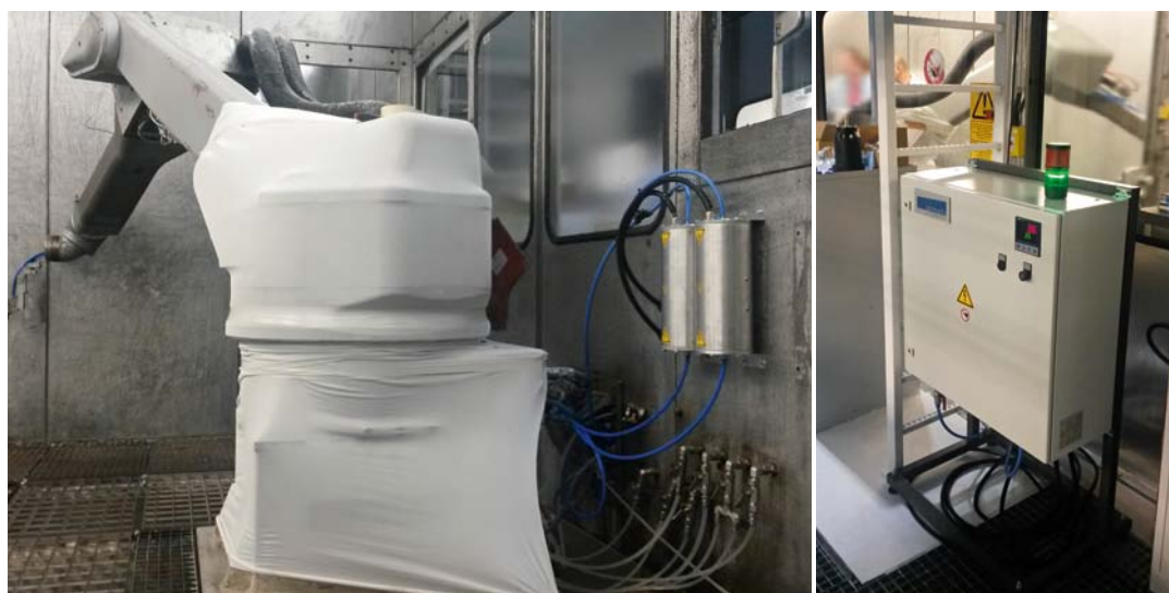
Druckluftaufbereitung mit ATEX-Zulassung in explosionsgefährdeten Bereichen.
